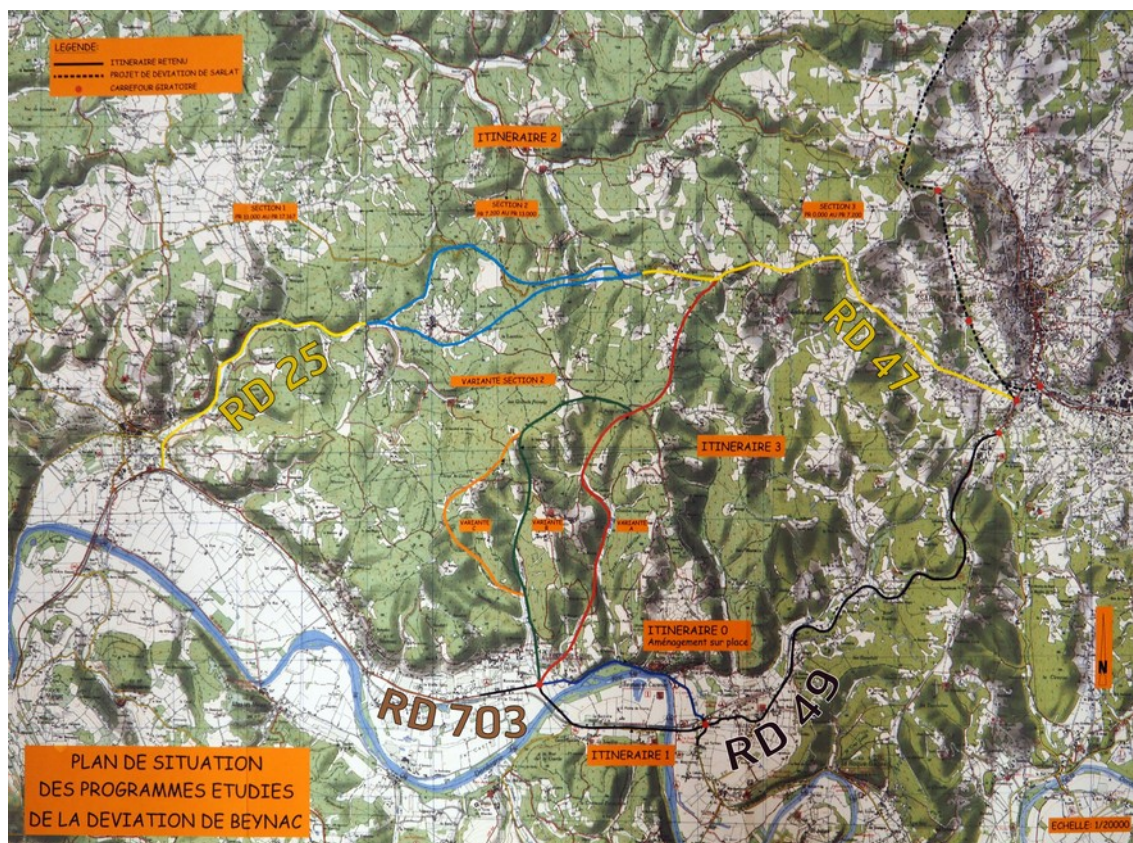
Les variantes longues et la variante courte retenue pour la déviation de Beynac ; Source Sépanso, complément CGEDD
